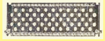
1895电车轨道加热器，由镍银丝制成，在瓷制的绝缘配件之间伸展（在1895年，由J. Houston和A. E. Kennelly，从“电加热”中引申出来）。
